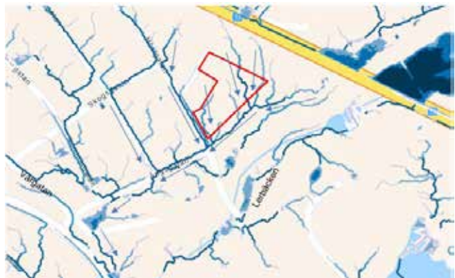
Figur 18. Flödesvägar och risk för översvämning vid skyfall
