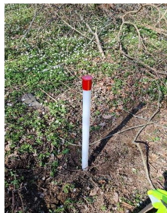
Figur 4. Grundvattenröret installerat i borrpunkt 23AF01.
