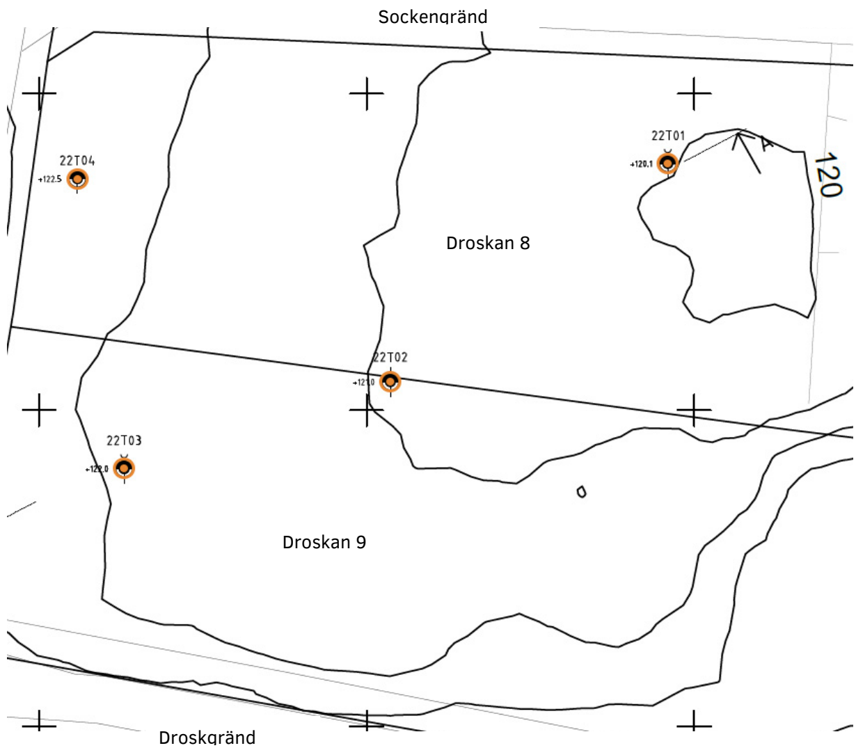
Figur 8. De orange/svarta cirklarna visar var den geotekniska utredningen har gjort undersökningspunkter och därmed höjdsatt de specifika punkterna. Punkt 22T01 är den lägsta punkten på +120,1.
