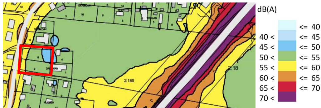
Figur 12. Ekvivalent ljudnivå 2 meter ovan mark från trafik, prognosår 2045. Planerade fastigheter för bostäder är markerade i rött. Oranget område i bullerkartan överskrider trafikbullerförordningens grundriktvärde för ljudnivå vid fasad.
