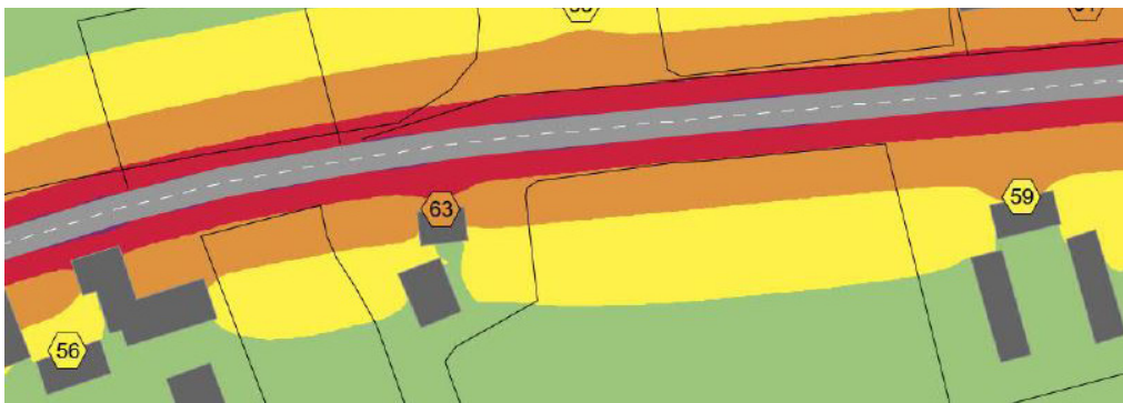
Figur 26. Utbyggnadens påverkan på bullernivåer för befintlig bebyggelse vid väg 1140. Överst bild på beräknade ekvivalenta ljudnivåer i nuläget och nedre bilden vid fullt utbyggt programförslag.
