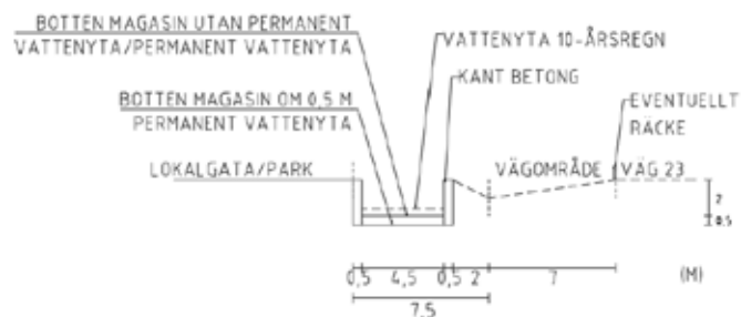
Typsektion förslag 2, med gjutna, vertikala kanter. Ramböll
