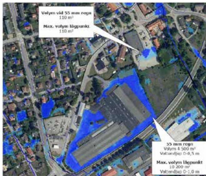
Figur 9 Skyfallskartering för 55 mm regn, Rambölls dagvatten- och skyfallsutredning
