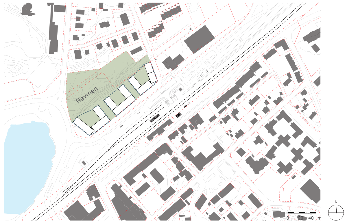
Ny bebyggelse i kvartersstruktur med sluten fasad mot gata.
