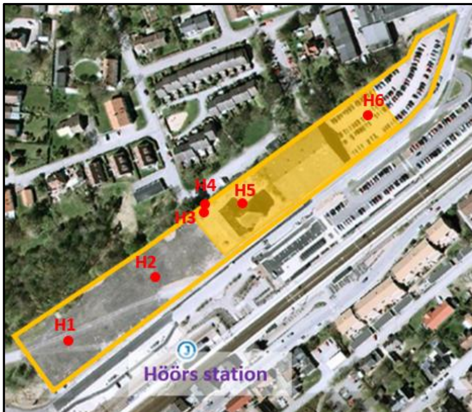
Figur 2. Upprättad provtagningsplan. Röda punkter markerar planerade provtagningspunkter för skruvprovtagning av jord.
