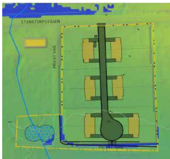
Figur 18, Simulerat regn på 44 mm. Föreslagen bebyggelse med de föreslagna åtgärder på markhöjning och diken.
