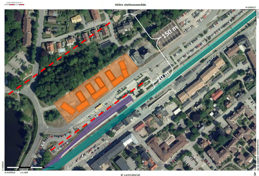
Figur 1. Illustration av det rekommenderade skyddsavståndet 20 m från närmsta befintliga spårkant på Södra stambanan, samt RIKTSAMS riskhanteringsavstånd på 150 m.
